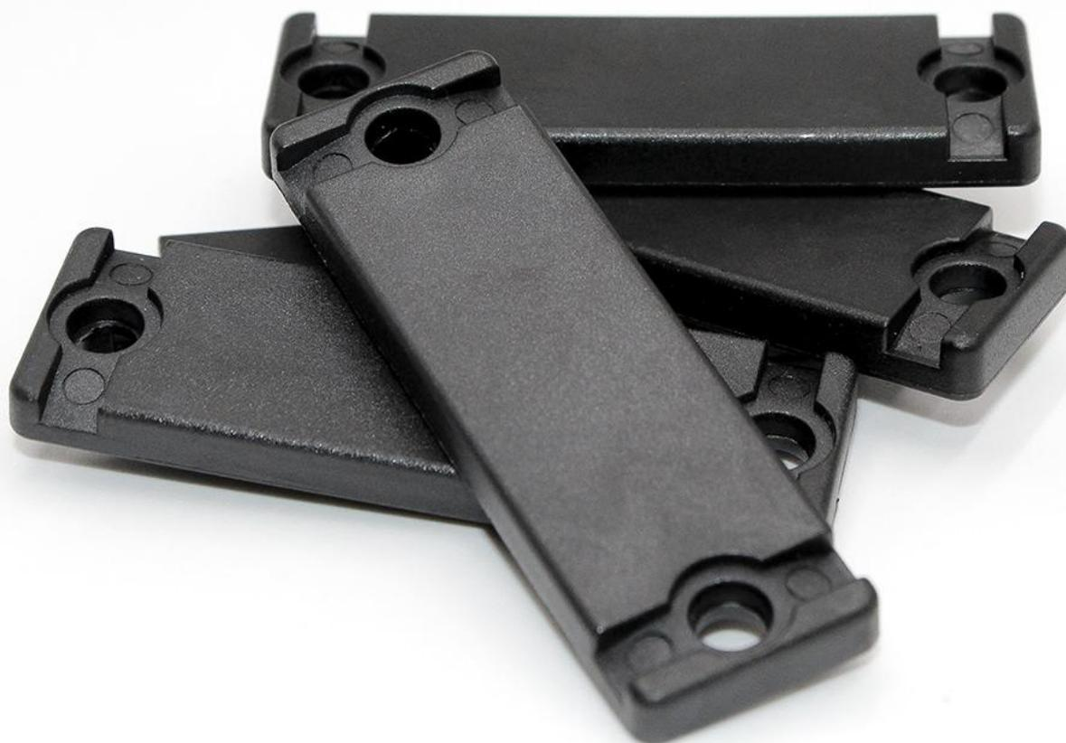
HT069 è un hard tag RFID in PPS, polimero termoplastico caratterizzato da elevata resistenza chimica, meccanica e alle alte temperature. Di forma rettangolare, pesa 8 grammi e le sue dimensioni sono 60,20 x 19,15 x 5,27 mm. **Adatto per essere applicato sul metallo** tramite adesivo o con il supporto di viti, è **molto resistente**
